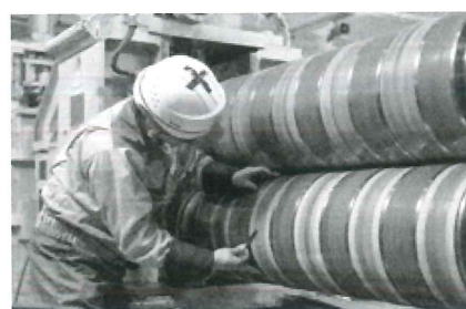
▲刃組み後、慎重にクリアランスを確認
